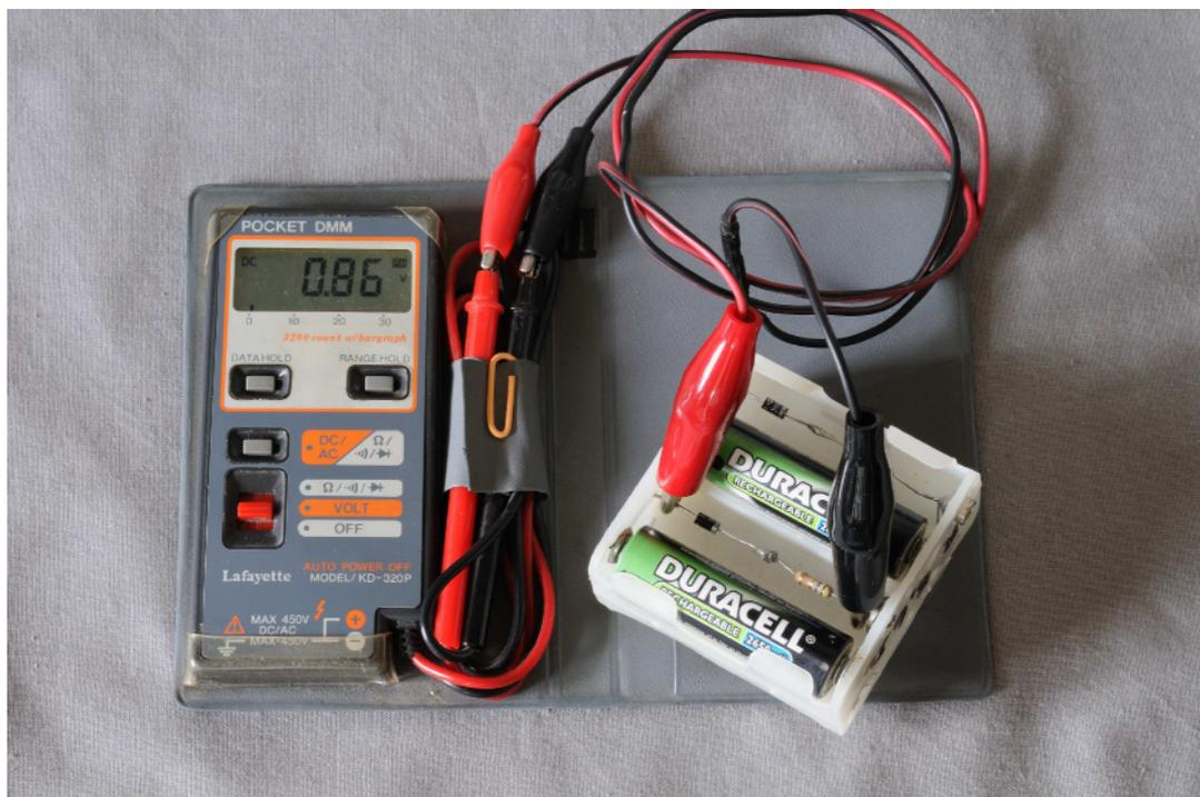
controllo in tempo reale dello stato di scarica (tensione residua sulle pile)
