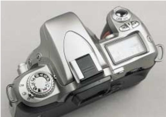
La calotta superiore della macchina, con i comandi in posizione classica. Il display a destra è di ampie dimensioni. A sinistra c'è la ghiera per la selezione delle funzioni.
