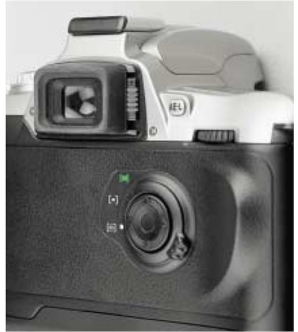
*Sul dorso, un selettore consente la scelta della modalità di lettura esposimetrica: multizonale, media con prevalenza al centro, spot. Accanto all'oculare c'è un cursore per la correzione diottrica. In alto si vede anche il pulsante AE-L, per memorizzazione dell'esposizione.*
