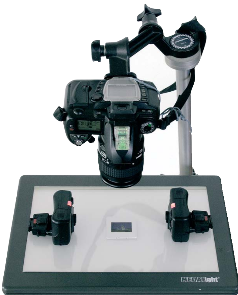
Una Nikon D70 con Micro Nikkor 60mm D inquadra una diapositiva posta su un negatoscopio ultrapiatto; ai lati due flash SB-R200.
