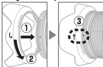
Allineare il riferimento di innesto paraluce (●) con il riferimento di allineamento paraluce (☒), quindi ruotare il paraluce (②) finché il riferimento ● non è allineato con il riferimento di blocco paraluce (—○).
