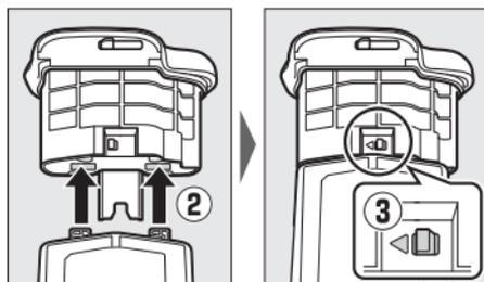
**Batterie/batterie ricaricabili AA:** posizionare otto batterie/batterie ricaricabili AA nel supporto batteria/batteria ricaricabile dell'MS-D12 come illustrato, assicurandosi che le batterie/batterie ricaricabili siano nell'orientamento corretto.
