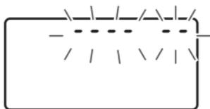
apre, consentendo di vedere il sensore di immagine. Il display del mirino si spegne e nel pannello di controllo lampeggerà una riga di trattini.
