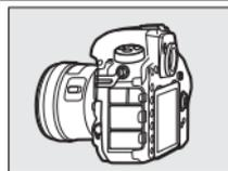
**Scatti ad angoli bassi:** basculare il monitor in alto per riprendere scatti in live view tenendo bassa la fotocamera.
