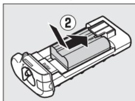
**EN-EL18c:** se il rilascio della batteria ricaricabile sul coperchio vano batteria BL-5 opzionale è posizionato in modo che la freccia ◁ sia visibile, far scorrere il rilascio della batteria ricaricabile in modo da coprire la freccia (①). Inserire le due sporgenze sulla batteria ricaricabile negli alloggiamenti corrispondenti sul BL-5 (②) e confermare che il rilascio della batteria ricaricabile si sia spostato di lato per rivelare la freccia (③).
