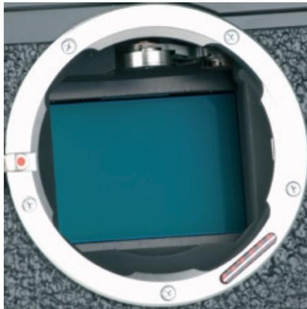
Il sensore è un CCD Full Frame, ovvero in formato Leica 35mm. Insomma, 24x36mm!
